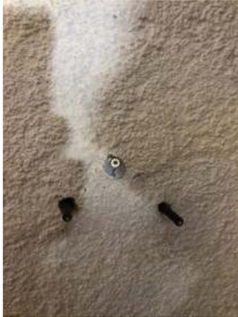
Montage der Messpunktes mit Markierung für Kontrollmessungen
