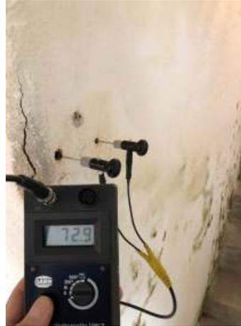
Feuchtigkeitsmessung an einem Messpunkt
