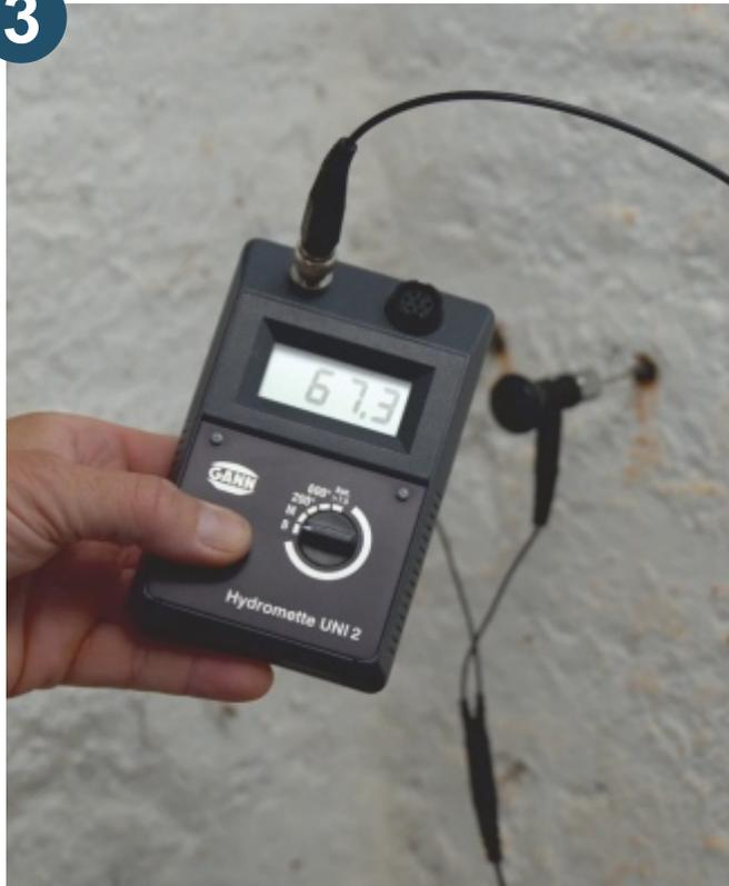
an Messpunkten angeschlossenes Messgerät
